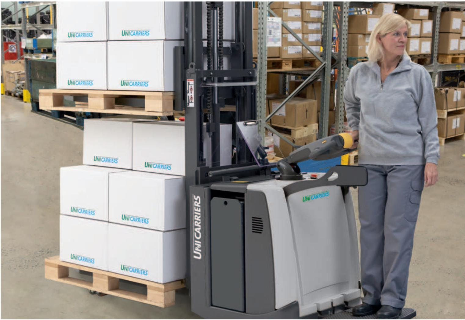
Schmäler als eine Europalette hat der PDP 200 eine Gesamtkapazität von 2.000 kg (1.000 kg + 1.000 kg im Doppelpalettenhandling) und eine maximale Hubhöhe von 2.090 mm. Sein 2,2 kW AC-Antriebsmotor und die Fahrgeschwindigkeit von bis zu 12,5 km/h tragen zu dem einzigartigen Paletten-durchfluss dieses effizienten Doppelstock-Staplers mit Fahrerstandplattform (optional) bei.
