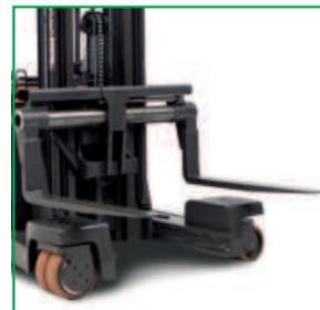
Die ausfahrbare Batterie, die einen einfachen Wartungszugang ermöglicht, gehört zur Standardausstattung. Eine auf Stahlrollen oder motorbetriebenen Stahlrollen platzierte Batterie für schnelle Batteriewechsel innerhalb einer Minute ist optional.
