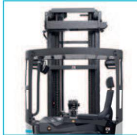
Die vollständig anpassbare Fahrerkabine gehört mit Mini-Lenkrad an der Armlehne und einem elektrisch höhenverstellbaren Boden zur Standardausstattung.
