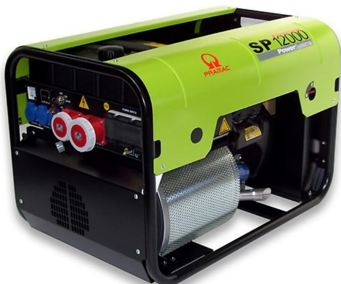
Dieser Stromerzeuger erfüllt die höchsten Ansprüche hinsichtlich Personenschutz (Isolationsüberwachung), Geräteschutz (Schutzklasse IP 54), Anlaufstromverhalten (elektronisch geregelter Synchrongenerator 4-fach I-Nenn) und Schiefastauglichkeit (unterschiedliche Belastung der einzelnen Phasen).
