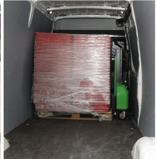
Nach der Beladung des Fahrzeuges klettert der Innolift einfach hinterher. Der Platzbedarf ist gleich wie bei einem herkömmlichen Handhubwagen.
