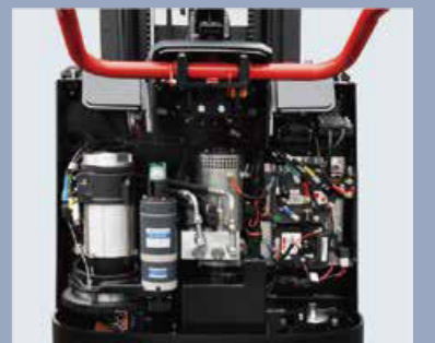
Die hintere Abdeckung kann vollständig geöffnet werden, und alle Komponenten und Teile sind auf einen Blick klar, was für die Wartung der gesamten Maschine sehr praktisch ist
