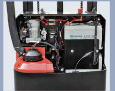
Die vollständig geöffnete Motorhaube ist leicht zu warten
