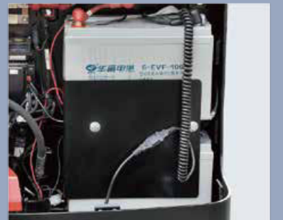
Eingebautes Ladegerät und wartungsfreier Gel-Akku, Sie müssen sich keine Sorgen machen
