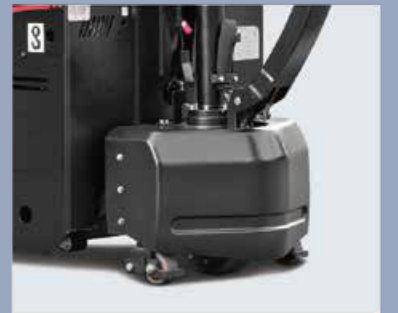
Zusätzliche Räder sind für eine bessere Stabilität ausgestattet
