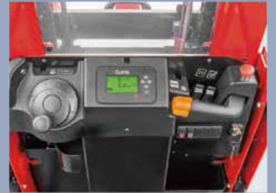
Der KOSTENLOSE Gashebel mit Sensorschalter kann standardmäßig Fehlfunktionen während der Arbeit verhindern
