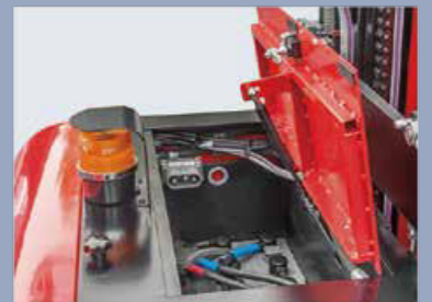
Die hintere Motorhaube kann leicht entfernt werden, um Wartungsarbeiten an Teilen wie Hydraulikeinheit, elektronischem Steuerungssystem und Motor zu erleichtern
