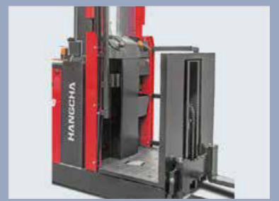
Die Kommissionierung funktioniert nur, wenn alle Seitenbarrieren abgesenkt sind
