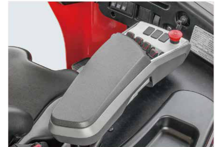
Fingerspitzenystem integriertes Steuerungssystem, mit gut Mensch-Maschine-Funktion
