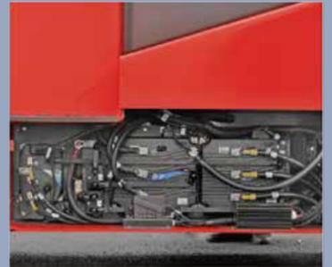
Sie können die Tür auf jeder Seite öffnen, wodurch die Wartung des Motors, der Ölpumpe und der elektrischen Steuerung sehr bequem ist und eine gute Wasser- und Staubdichtigkeit gewährleistet ist.
