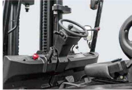
/ Der ergonomisch gestaltete einstellbare Lenkradwinkel und der einstellbare Sitzabstand von 150 mm bieten einen besseren Fahrerkomfort für verschiedene Fahrer.
