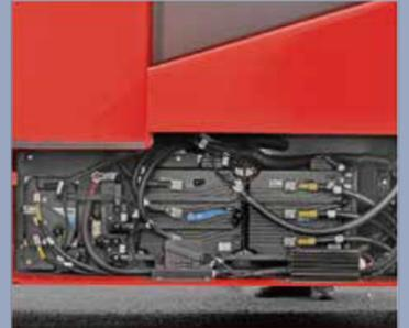
Sie können die Tür auf jeder Seite öffnen, wodurch die Wartung des Motors, der Ölpumpe und der elektrischen Steuerung sehr bequem ist und eine gute Wasser-
