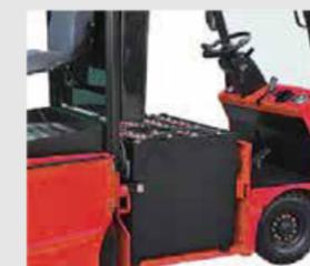
Seitenwechsel Batterie Design ist praktisch zum Batteriewechsel
