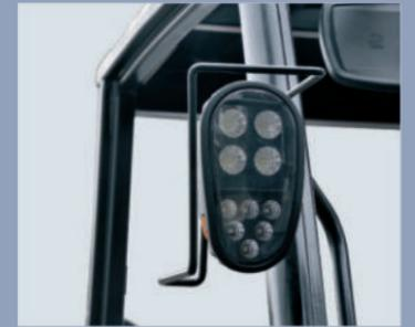
Das neue effiziente Beleuchtungssystem verwendet LED-Leuchtmittel und einen neuen Typ Reflektor zur Reduzierung des Energieverbrauchs, die Beleuchtungsleistung wird deutlich verbessert
