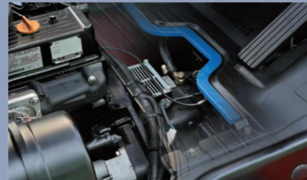
1. Neben dem Gummidämpfer zwischen Rahmen und Lenkachse erreichen der Verbundmotordämpfer und der vollschwimmende Antriebsstrang eine flexible Verbindung zwischen Rahmen und Antriebssystem, wodurch Fahrvibrationen des Antriebssystems erheblich reduziert werden.
