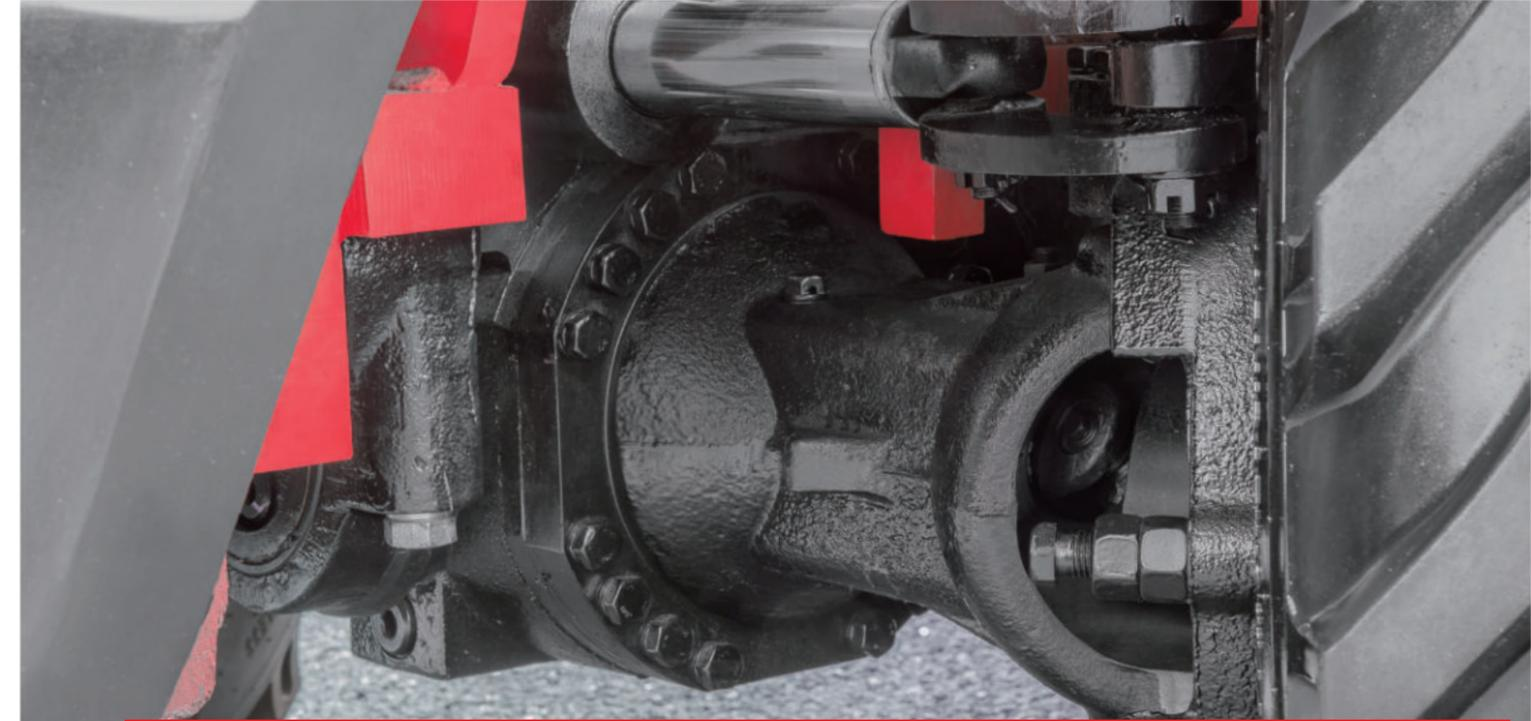
Die oszillierende Lenkachse ermöglicht es jedem Rad Hindernisse zu überwinden und hält die Ladestufe.
