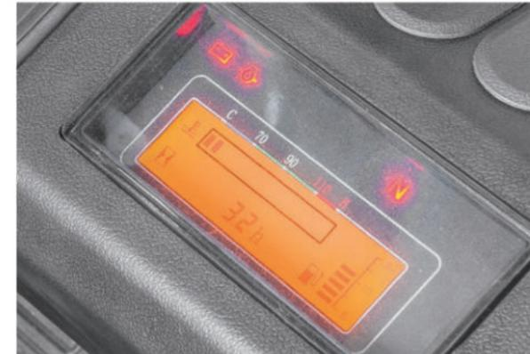
Das neu entwickelte LCD-Instrument verfügt über umfassende Funktionen, eine stabilere Leistung und kann den vollständigen Status, den Fehlercode und andere wichtige Informationen des Staplers vollständig anzeigen, sodass der Bediener den Status intuitiver verstehen kann und erleichtert die Wartung.
