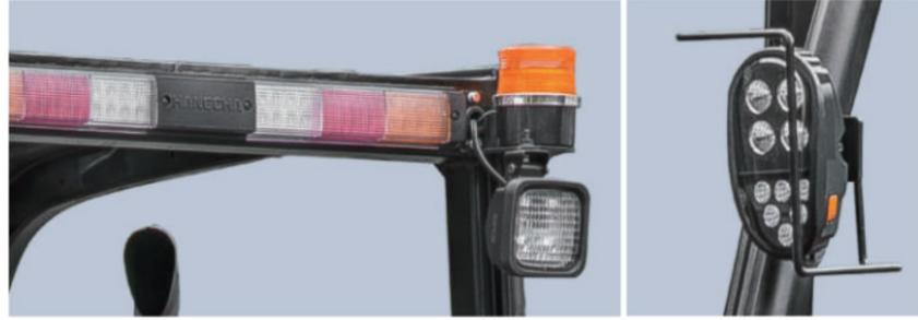
Das neue Effizienzbeleuchtungssystem verwendet LED-Leuchtmittel und einen neuartigen Reflektor, um den Energieverbrauch zu senken und die Beleuchtungsleistung erheblich zu verbessern.
