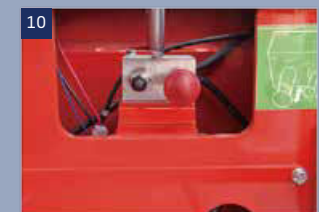
Manuelles Entlastungsventil: Wenn sich die Maschine nicht bewegen kann, können Sie die Maschine nach dem Drücken dieses Ventils drücken
